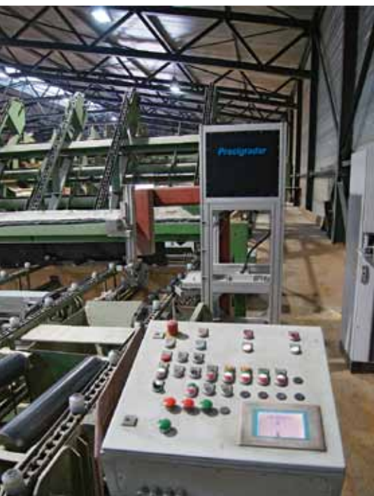
Nachsortierung: Der Precigrader bestimmt bei Belwood die Festigkeit trockener Ware
