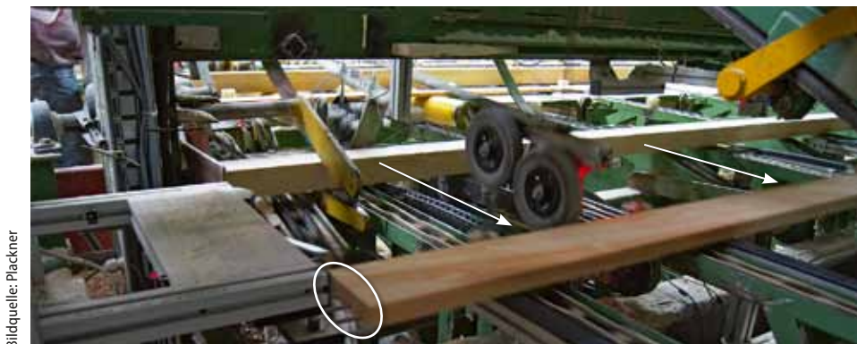
Der Precigrader klopft auf die Stirnseite jedes vorbeieilenden Brettes – vier Mikrofone (Kreis) nehmen den Klang auf, über dessen Frequenz die voraussichtliche Festigkeit bestimmt werden kann
