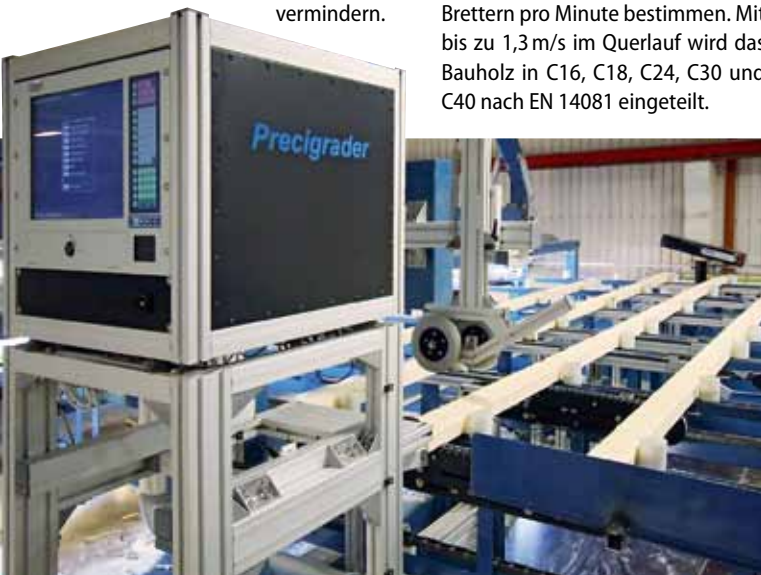
Bei bis zu 180 Brettern pro Minute klopft der Limab-Precigrader an der Stirnseite an und bestimmt über den Klang die Holzfestigkeit
