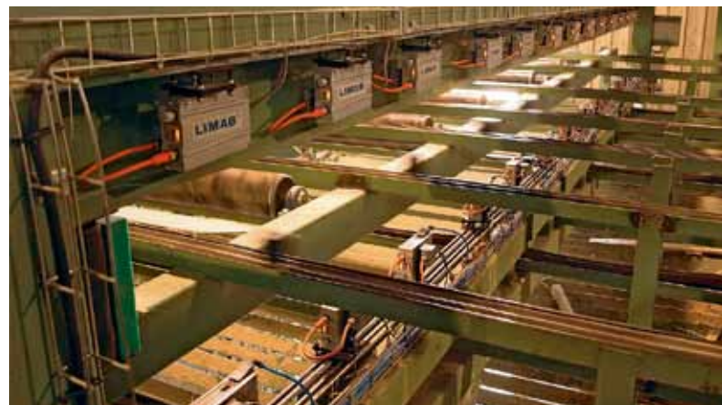
Boardprofiler in der Praxis: Bei Haas Holzindustrie in Chanovice bestimmt eine Limab-Installation die Brettgeometrie bei der Vorsortierung
