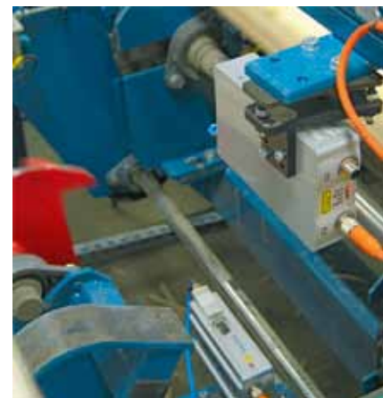
Zwei Lasersensoren ergeben beim Boardprofiler eine Messspur
