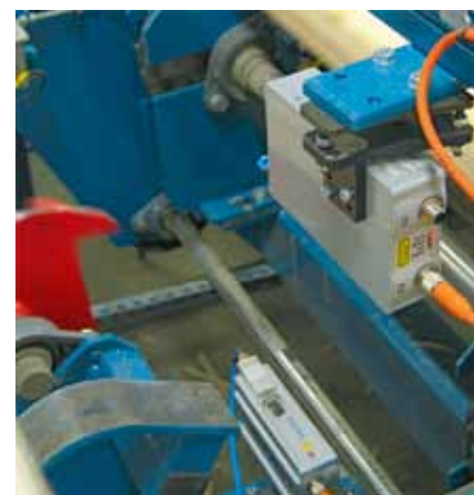
Zwei Lasersensoren ergeben beim Boardprofiler eine Messspur
